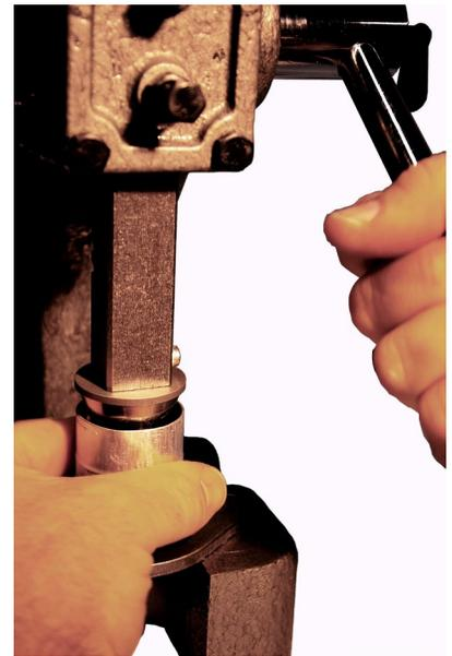
6. Avec la main gauche faisant tourner le boîtier sur le support de coquille, la main droite doit appliquer une pression ferme sur la poignée du vérin lors de la course vers le bas. Sans retirer complètement la matrice d'expansion de l'embouchure du boîtier, le vérin doit être soulevé puis abaissé plusieurs fois. Ce processus doit être répété jusqu'à ce que l'embouchure de l'étui soit suffisamment arrondie pour accepter l'emplacement d'un projectile.
