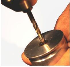
a. Percez la poche d'amorce en laiton de la charge propulsive coincée avec le foret #18. [Si vous rechargez un boîtier CTS, un foret #24 est nécessaire pour ouvrir le trou d'éclair de l'insert métallique de l'intérieur du boîtier en plastique.]
