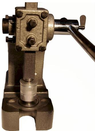
11. Placez le boîtier sur le bloc de siège de charge propulsive de manière à ce que la cartouche saillante soit sur le dessus. Abaissez délicatement le vérin en tournant lentement la poignée pour mettre le poinçon d'assise en contact avec la charge propulsive. Exercez une pression ferme et constante sur la poignée du vérin pour placer la nouvelle cartouche au ras du
