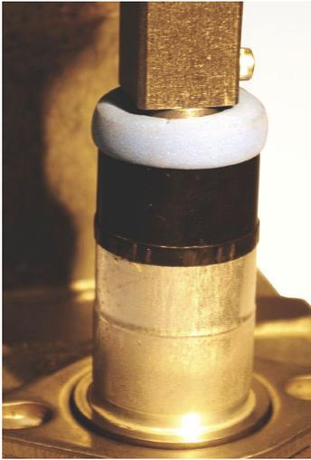
douille sur une surface solide et appuyez sur le projectile avec votre main. Parfois, il peut être nécessaire de placer le projectile avec la presse de rechargement. Pour ce faire, retirez le bloc d'assise de la plaque de coque et placez le boîtier apprêté dans le support de coque. Alignez le projectile avec l'embouchure du boîtier et abaissez le béliet en tournant la poignée. Le poinçon
