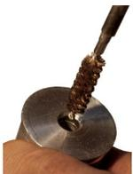
7. Nettoyez l'orifice de charge propulsive à l'aide d'une brosse de calibre .40 (non incluse) pour vous assurer qu'il est propre et exempt de débris. N'utilisez PAS de solvant pour nettoyer le trou, car cela pourrait endommager les boîtiers.
