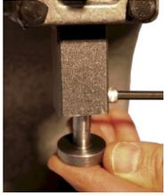
2. Insérez complètement le poinçon de siège de charge propulsive dans le vérin et serrez à la main la vis de réglage avec une clé mâle hexagonale de 5/32" pour maintenir le poinçon de siège en place.
