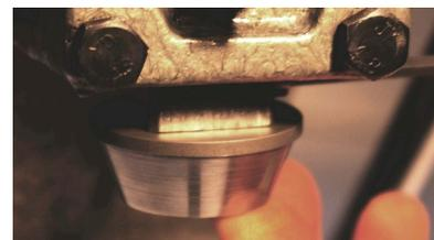
3. Utilisez le bâton de lubrifiant à la cire pour appliquer une fine ligne de lubrifiant autour de la face biseautée de la matrice d'expansion TX-40™.
