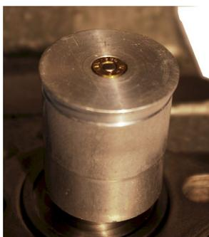
Si la charge propulsive n'est pas parfaitement alignée, essayez de charger l'obus dans le lanceur pour vous assurer que la brèche se fermera complètement. La charge propulsive n'a pas besoin d'être parfaitement affleurante, il suffit de la chamberer et de permettre à la brèche de se fermer.
