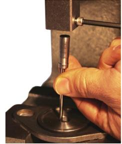
3. Placez la plaque de coque côté plat vers le bas dans la bride d'alignement de la presse de rechargement. Placez une douille dans la plaque
