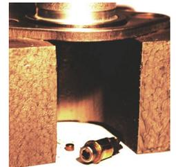
5. Les boîtiers DefTech ont souvent une coupelle d'éclatement en laiton pressée dans le trou de charge de propulsion. **Retirez-le avant de recharger !** Pour l'enlever, utilisez un foret Lettre T (non inclus) à très basse vitesse avec une légère pression pour saisir la tasse. Retirez-le pendant que le foret tourne.
