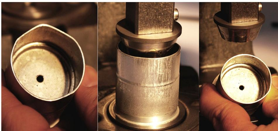
Étapes d'utilisation de la matrice d'expansion TX-40 pour réparer les bouches de boîtier bosselées:
