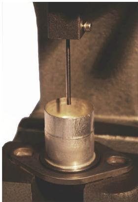
d'obus avec la charge propulsive vers le bas. Abaissez délicatement le bélier en tournant lentement la poignée. Assurez-vous que la goupille d'extraction n'est pas pliée et qu'elle pénètre facilement dans le trou d'éclair du boîtier. Juste à l'intérieur du flash-hole, la goupille entrera en contact avec la charge propulsive
